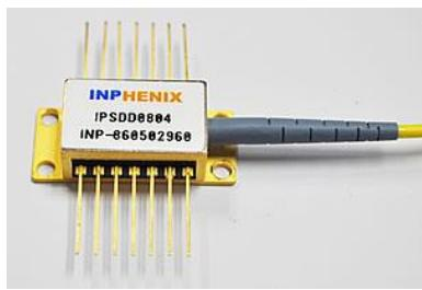
スーパールミネセントダイオード(Superluminescent Diode “SLD”)は、端面放射型の半導体光源です。特徴は、電流注入型レーザーダイオード(LD)のような高光出力と小さいビーム広がり角と、発光ダイオード(LED)のような広帯域のスペクトラムと低コヒーレンスにあります。半導体レーザー(LD)同様の大きさでありながら、LD のレーシングに利用されるオプティカルフィードバックメカニズムを所有しておりません。LD と比較した主な特徴は、より高い利得、より高い電流密度、そして活性領域内におけるより強い光子とキャリア密度分布の不均一性にあります。構造は、端面の反射率を低下させてレーシングを抑制する LED の構造に似ています。低い電流値では LED のように動作しますが、高い電流値では光出力が超線形に増加します。
