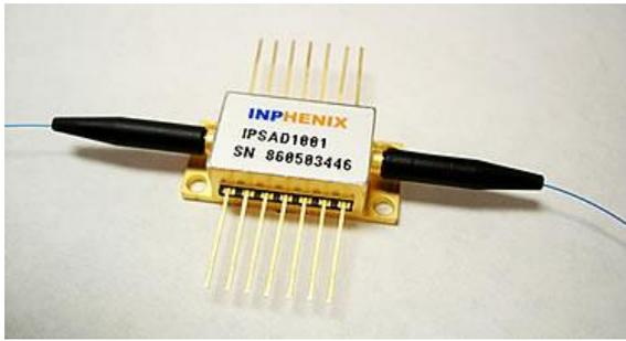
半導体光増幅器 (Semiconductor Optical Amplifier “SOA”)は、本質的には入出力ポートにフィードバックがないレーザーダイオード (LD)であり、そのため進行波増幅器 (Traveling-Wave Amplifier “TWA”)とも呼ばれています。柔軟性のある多機能デバイスとしての応用実績が豊富で、光ファイバーネットワ
